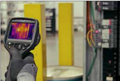
Laserpointer markieren das Zielobjekt für Tageslicht-Referenzbilder.
